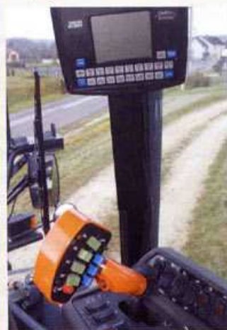
La cabine a beaucoup évolué. Comparable à celle d'un tracteur, elle dispose par exemple d'une console de commande complète. Les vues avant et arrière sont très dégagées.
