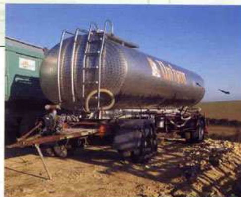
Le ravitailleur de 15 000 l pour épandre l’azote liquide.
